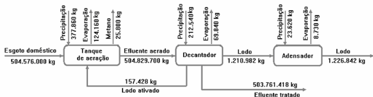
Figura 2. Fluxograma de massa mostrando os principais fluxos da Estação de Tratamento de Lodo Ativo (Cálculos Anexo A). A quantidade de metano está calculada no anexo B.
